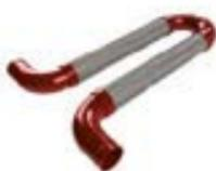
I giunti antisismici scanalati in AISI 316L rivestiti in AISI 304 sono utilizzati per assorbire vibrazioni e movimenti causati da terremoti, muovendosi in 6 direzioni differenti riescono a garantire la continuità e l'integrità dell'impianto.
