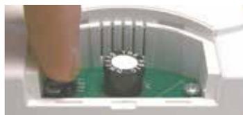
Inserire il sensore e premere il tasto di test per 3 secondi. Richiudere lo sportello con una leggera pressione
