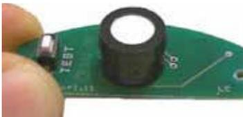
Verificare che il modulo sensore di ricambio sia identico a quello da sostituire (in caso di errore lo strumento va in allarme)
