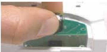
Inserire il sensore di ricambio, disponibile nell'apposito blister, e bloccarlo tramite le apposite viti
