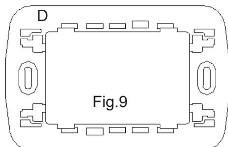
Con questa "**Cornice portaplacca**" (Fig.9) si possono montare le placche delle seguenti serie civili senza effettuare nessuna modifica:
