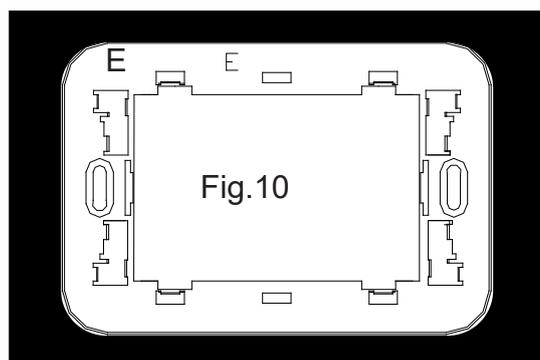
Con questa **Cornice portaplacca** (Fig.10) si possono montare le placche delle seguenti serie civili senza effettuare nessuna modifica:
