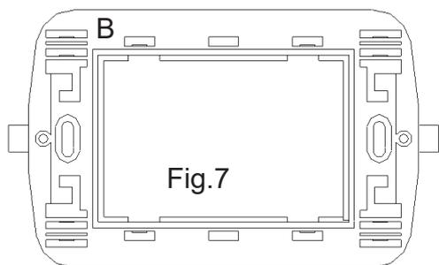
Con questa "**Cornice portaplacca**" (Fig.7) si possono montare le placche delle seguenti serie civili senza effettuare nessuna modifica:
