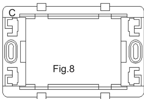
A richiesta, il cronotermostato da incasso **Green Wi-Fi** ha la possibilità di montare la "**Cornice portaplacca C**" (Fig.8) che permette il montaggio delle seguenti placche civili senza effettuare nessuna modifica:
